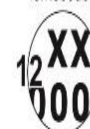
12 Impressão InkJet na cor preta contendo código de check rondômico contendo 3 letras e 5 números impressos abaixo da massa raspável.
